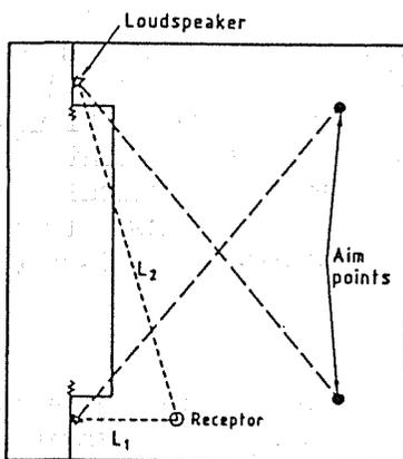
Fig. 1. ILLUSTRATION OF EFFECT OF WIDE HALL ON TRANSIT DISTANCES FOR WIDELY SEPARATED LOUDSPEAKERS. ( $L_2 \gg L_1$ )
