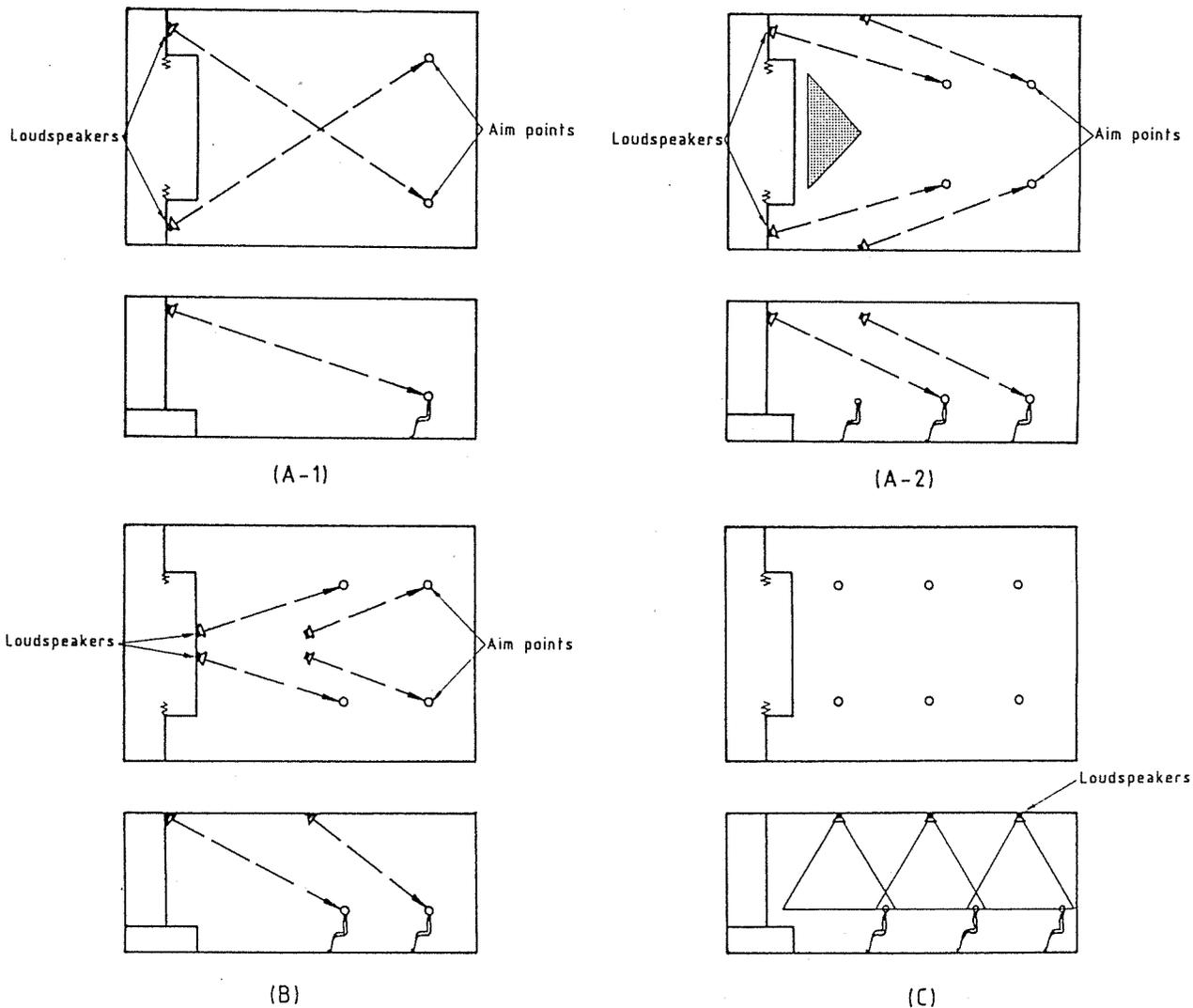
Fig. 5 (A-1). LOUDSPEAKERS ON EITHER SIDE OF STAGE PROSCENIUM
