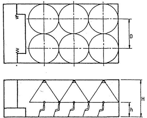
Fig. 7. BASIS FOR LAYOUT OF DISTRIBUTED CEILING SPEAKERS. ( $D \leq 2(H - h)$ )
