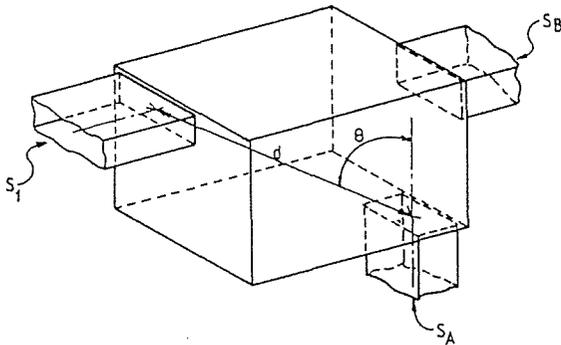
Fig. 9. TYPICAL PLENUM CHAMBER GEOMETRY.
